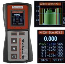
Misura la tensione DC di cella, la densità (SG) e la temperatura dell'elettrolita di una batteria stazionaria. Normalmente questo avviene con l'impiego di due tecnici: uno esegue le misure mentre l'altro scrive i risultati. Con Battlogger Plus tutto viene automatizzato.
